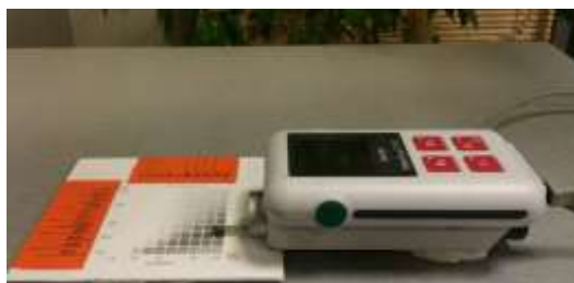
5.attēls Ar lāzera apstrādātās virsmas raupjuma mērīšana ar virsmas struktūras mērīšanas ierīci MarSurf PS1
