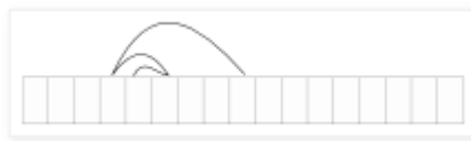
3. attēls Binārās meklēšanas darbības princips
