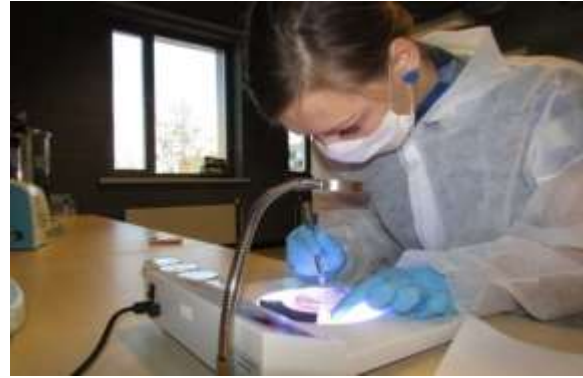
2. attēls Mikroorganismu koloniju saskaitīšanas process ar Funke Gerber koloniju skaitītāju
