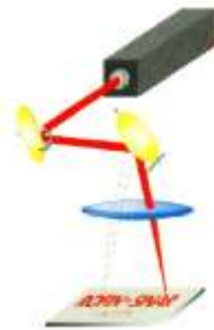
2.attēls Skanēšanas galvas funkcionālais princips
