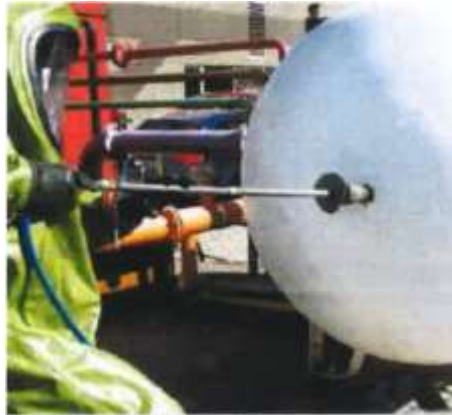
3.att. Bojātas tvertnes hermetizācija, izmantojot pneimatisko tapu
