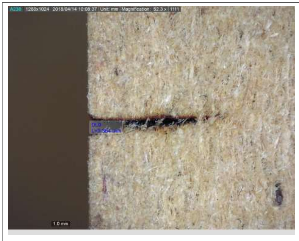
4. attēls. MDF 10 mm plātnes lāzergriezums, kur griešanas ātrums V=8 mm/s un jauda P=\text{const.}=30 W
