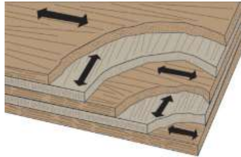
2.attēls. Saplākšņa šķiedru kārtu virzieni [5]
