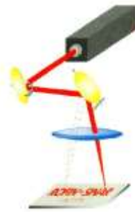
2.attēls Skanēšanas galvas funkcionālais princips
