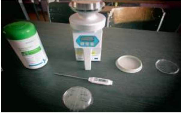
1. attēls M-Air-T Milipore gaisa testeris, vienreizējas barotnes, termometrs, dezinfekcijas salvetes
