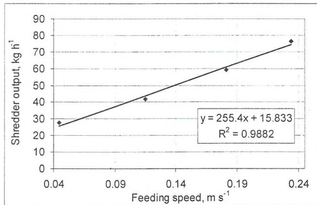
Fig. 5. Shredder output
