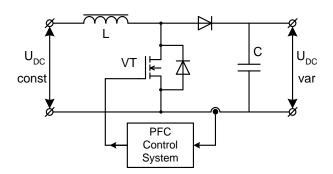
Fig. 8. PFC (DC/DC) module.
