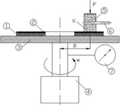
Fig.2. TABER-ABRASER test machine
